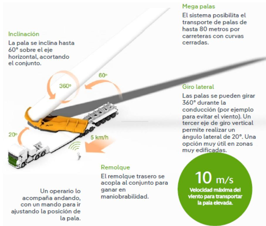
Ilustración 23: Diagrama sistema Blade Lifter de Iberdrola
