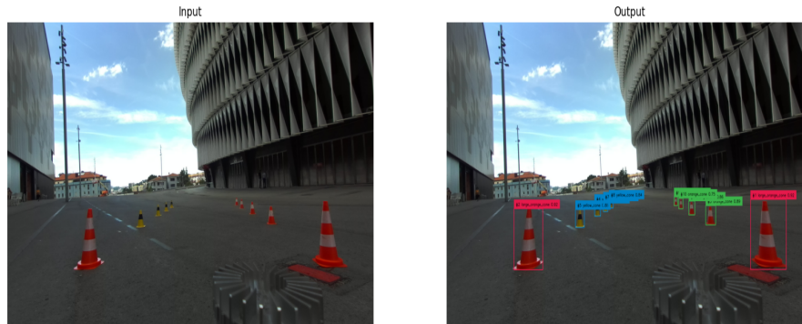
Figura 39: Inferencia y tracking de conos
