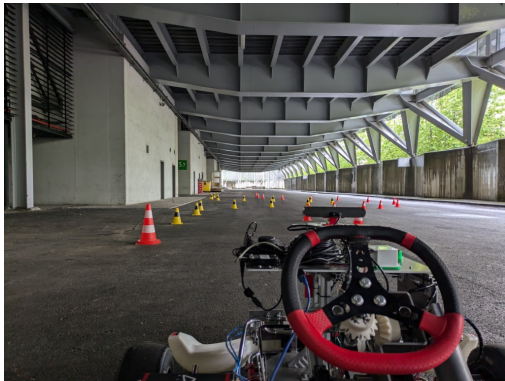
Figura 50: EKF SLAM en pista con curvas
