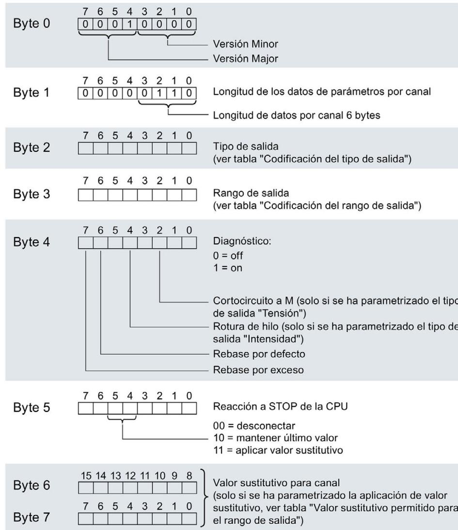
Figura B-3 Estructura del juego de datos 64: bytes 0 a 7
