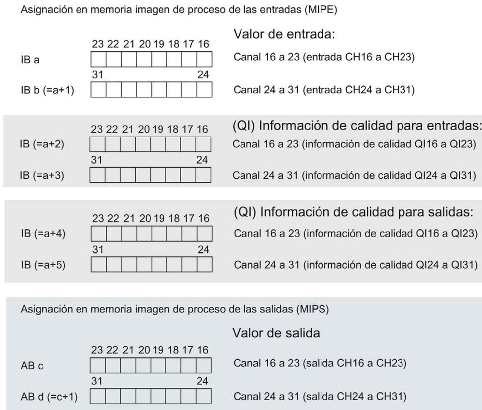
Figura 5-3 Espacio de direcciones del submódulo X12 de la periferia digital integrada de 2 x 32 canales (16 entradas digitales/16 salidas digitales) con información de calidad
