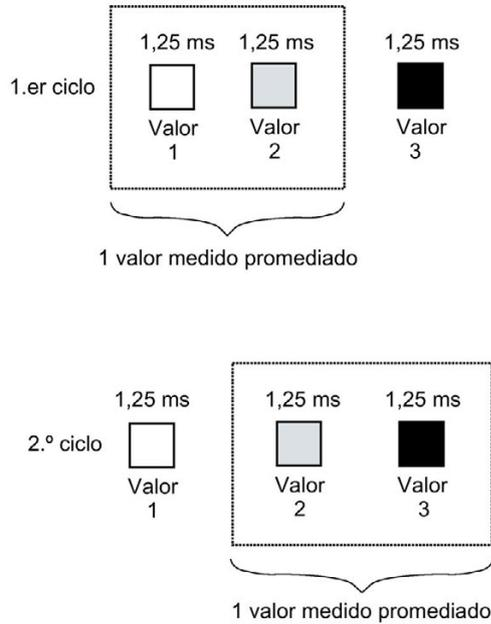
Figura C-1 Supresión de frecuencias perturbadoras 400 Hz
