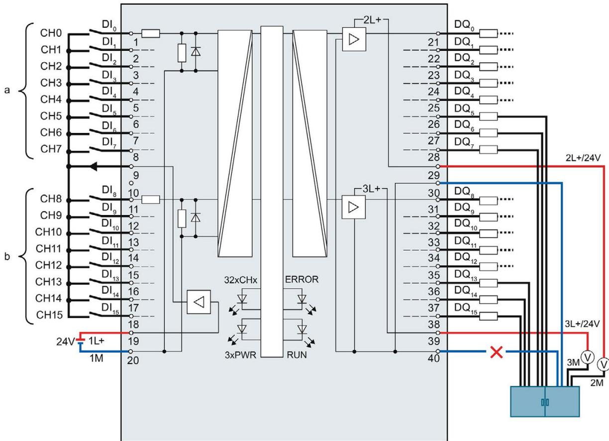
Figura 4-16 Ejemplo de interrupción del segundo cable de masa en la periferia digital integrada X11
