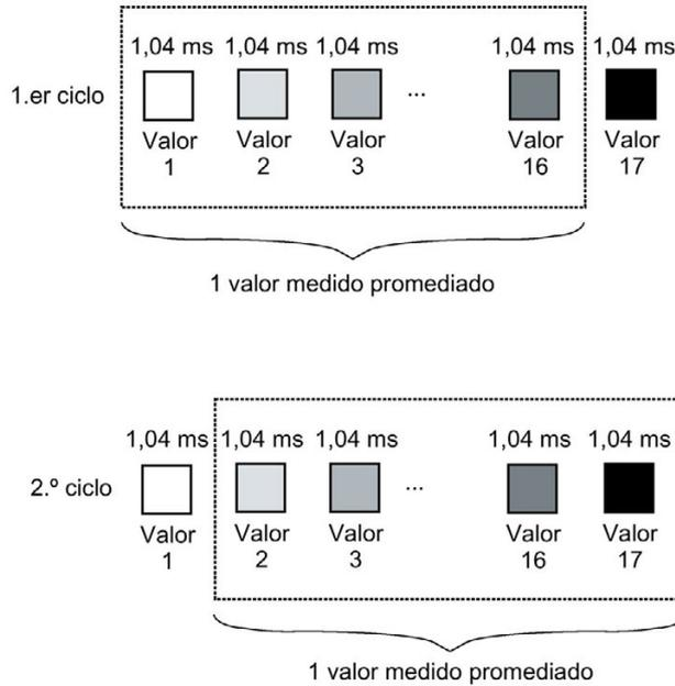
Figura C-2 Supresión de frecuencias perturbadoras 60 Hz
