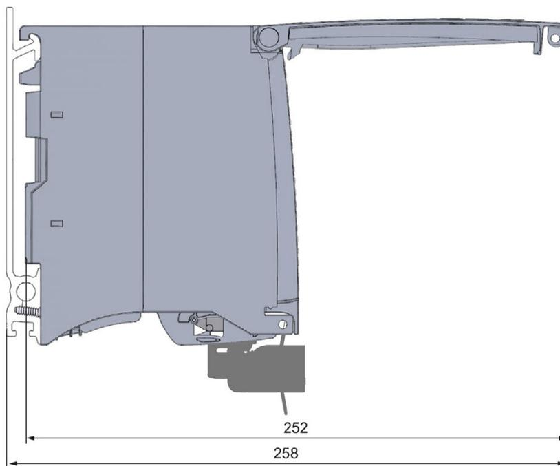
Figura A-2 Croquis acotado de la CPU 1512C-1 PN, vista lateral con tapa frontal abierta
