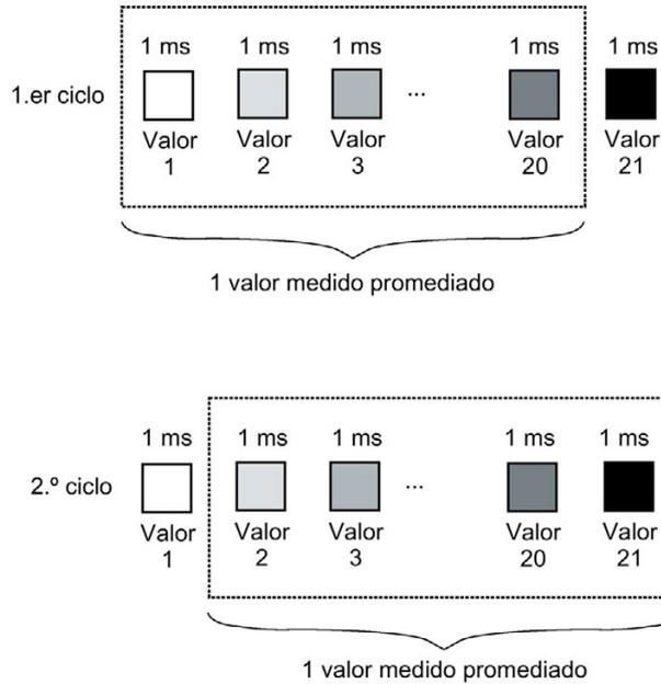
Figura C-3 Supresión de frecuencias perturbadoras 50 Hz
