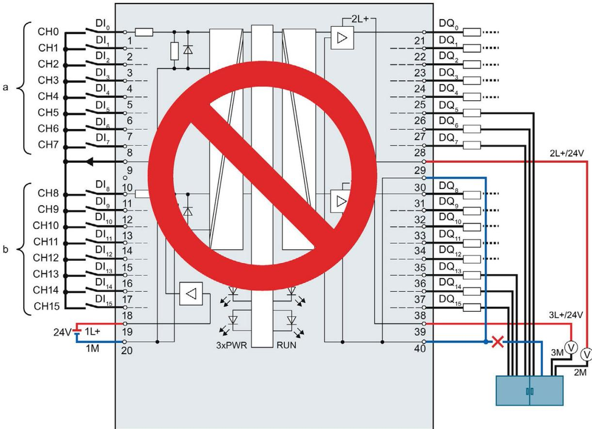
Figura 4-18 Ejemplo de cableado erróneo en la periferia digital integrada X11: puente
