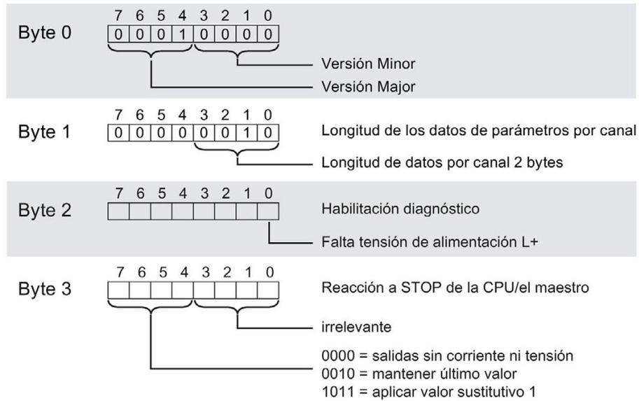
Figura B-5 Estructura del juego de datos 64: bytes 0 a 3
