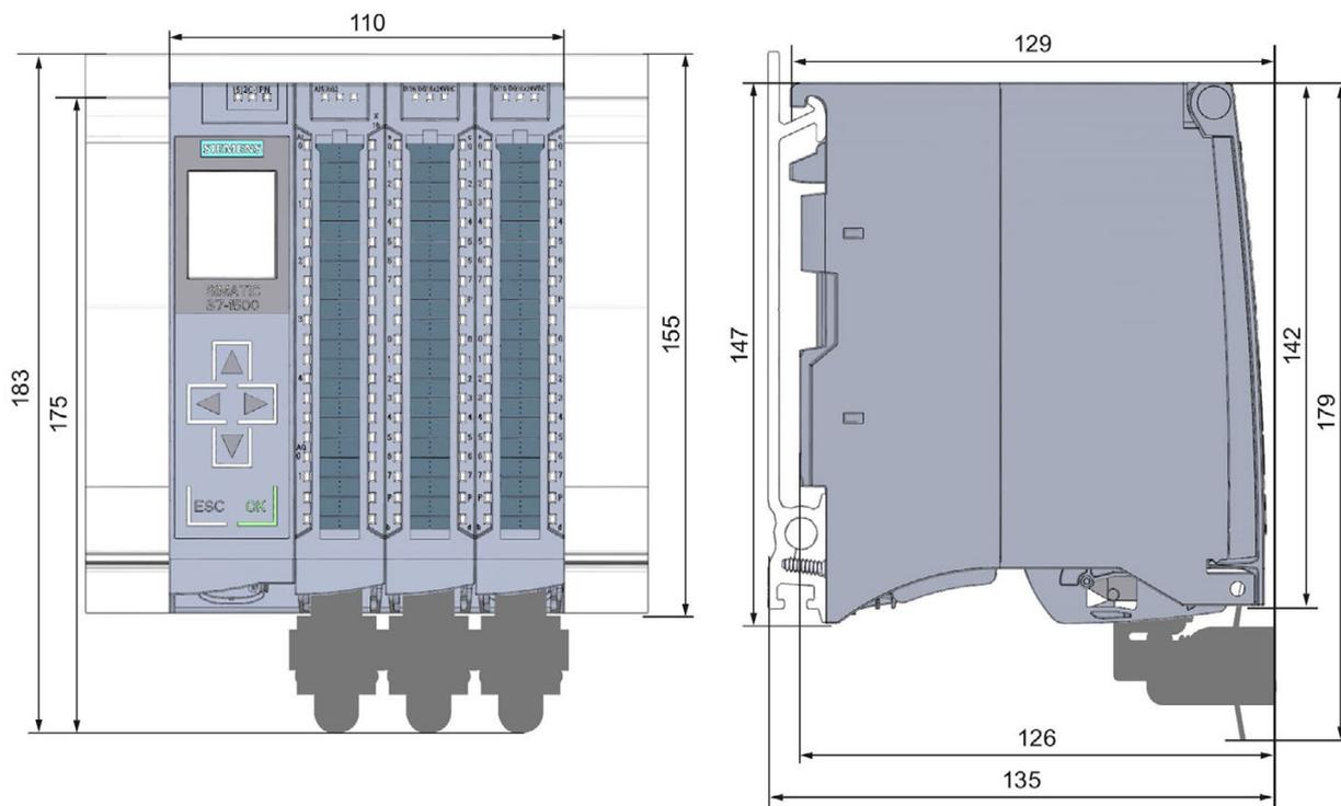
Figura A-1 Croquis acotado de la CPU 1512C-1 PN , vistas frontal y lateral
