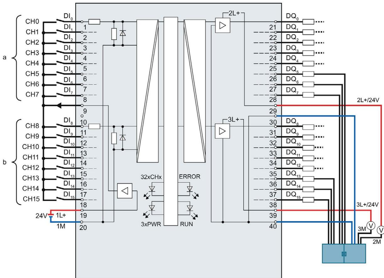
Figura 4-13 Ejemplo de cableado correcto en la periferia digital integrada X11
