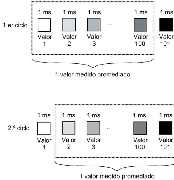
Figura C-4 Supresión de frecuencias perturbadoras 10 Hz
