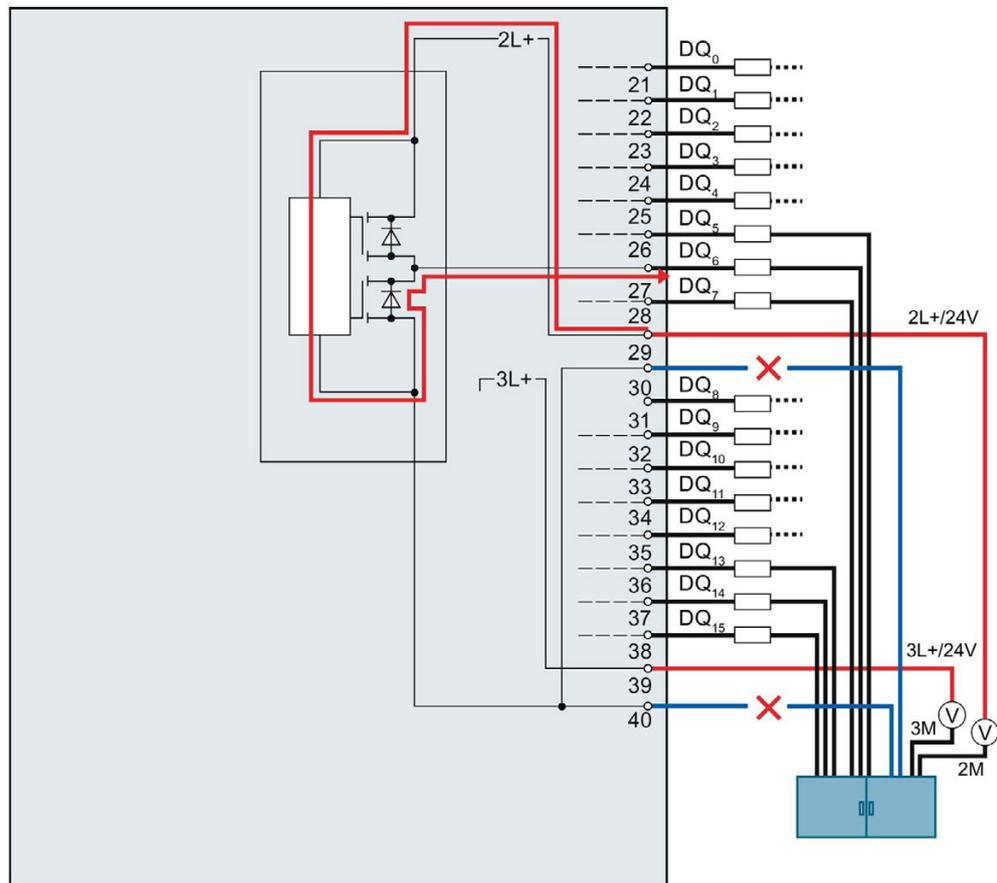
Figura 4-17 Ejemplo de circulación de corriente en caso de interrupción de los dos cables de masa en la periferia digital integrada X11
