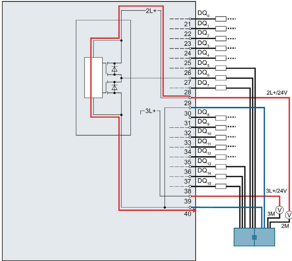
Figura 4-14 Ejemplo de circulación de corriente en caso de cableado correcto en la periferia digital integrada X11
