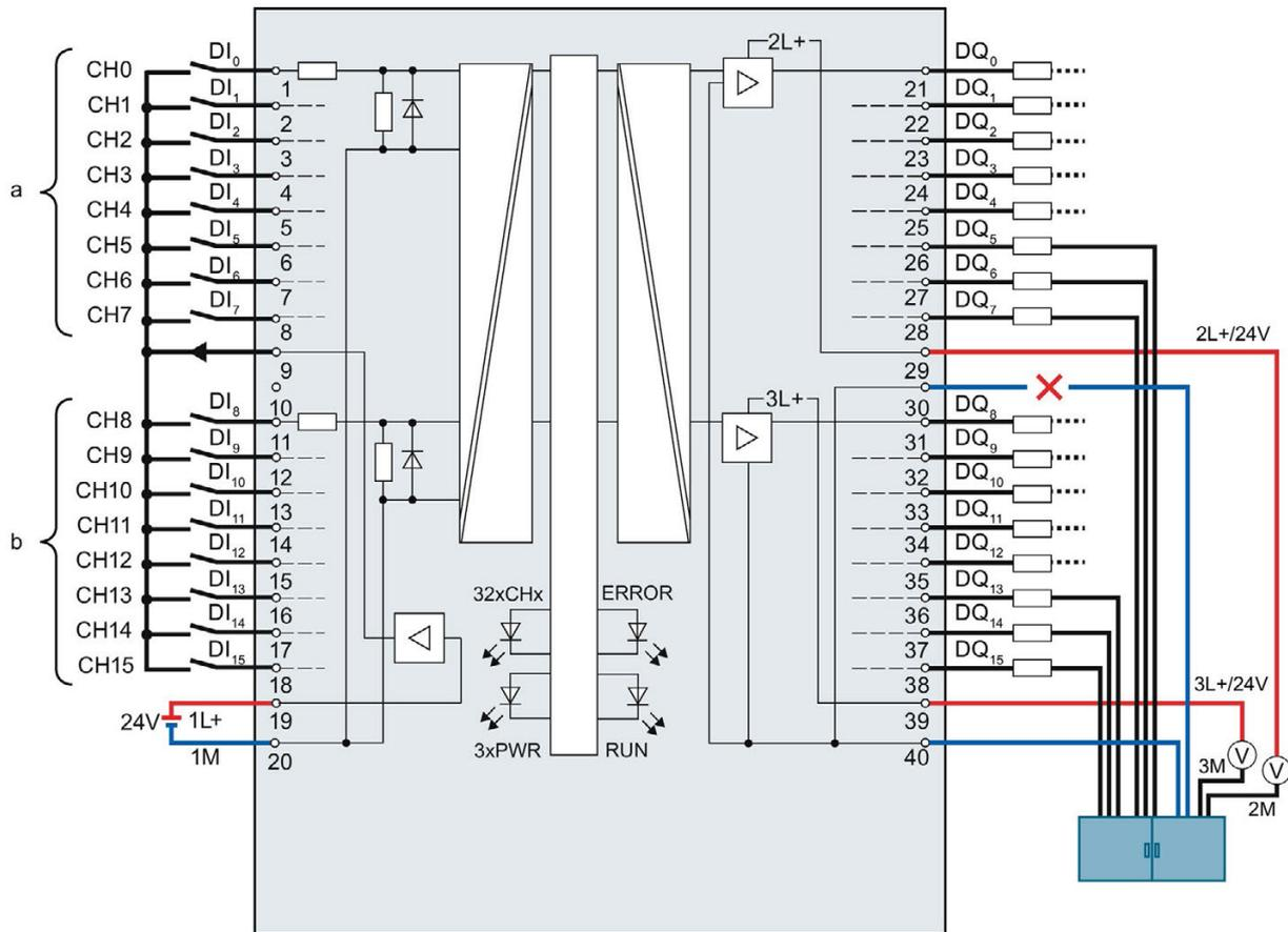
Figura 4-15 Ejemplo de interrupción del primer cable de masa en la periferia digital integrada X11
