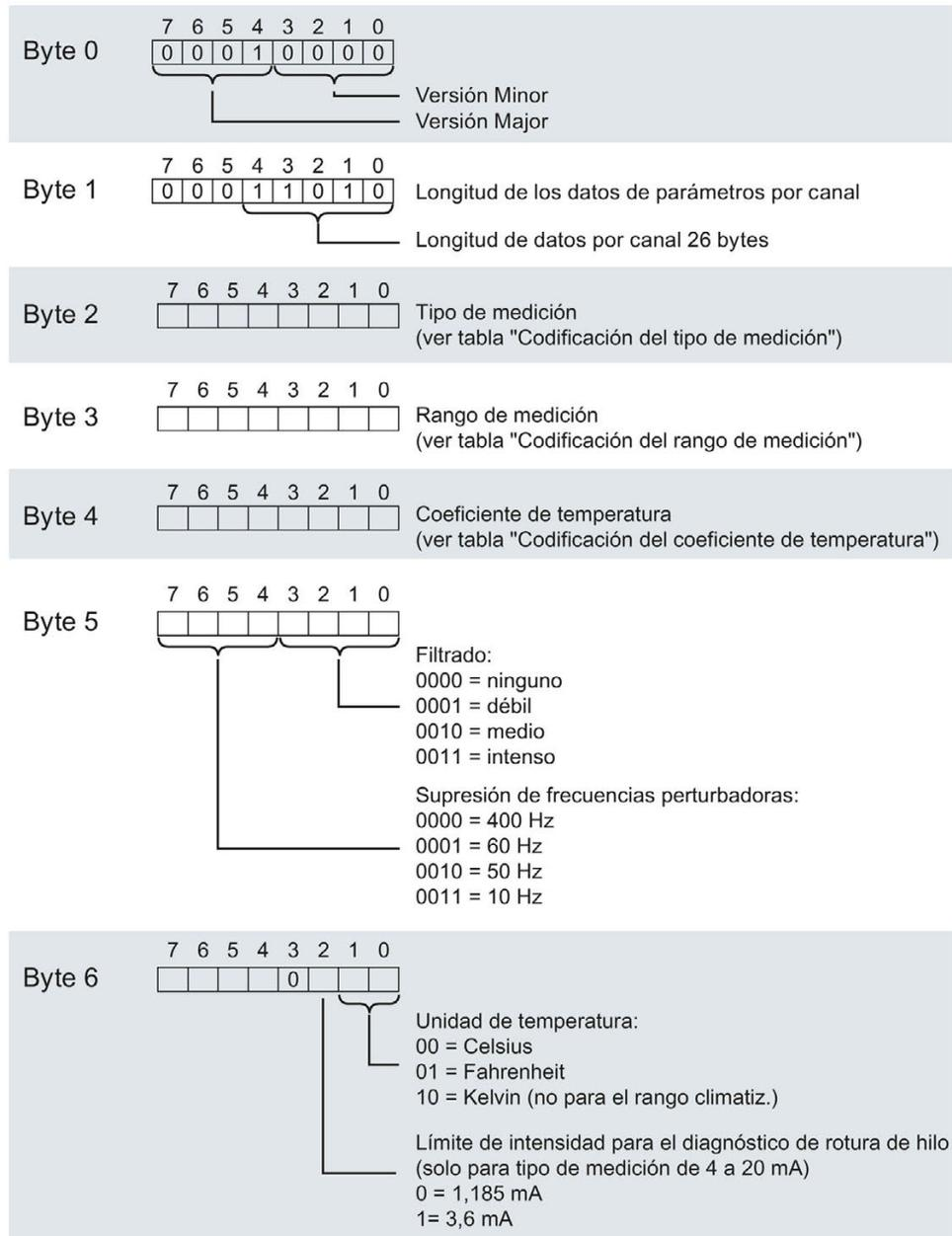
Figura B-1 Estructura del juego de datos 0: bytes 0 a 6
