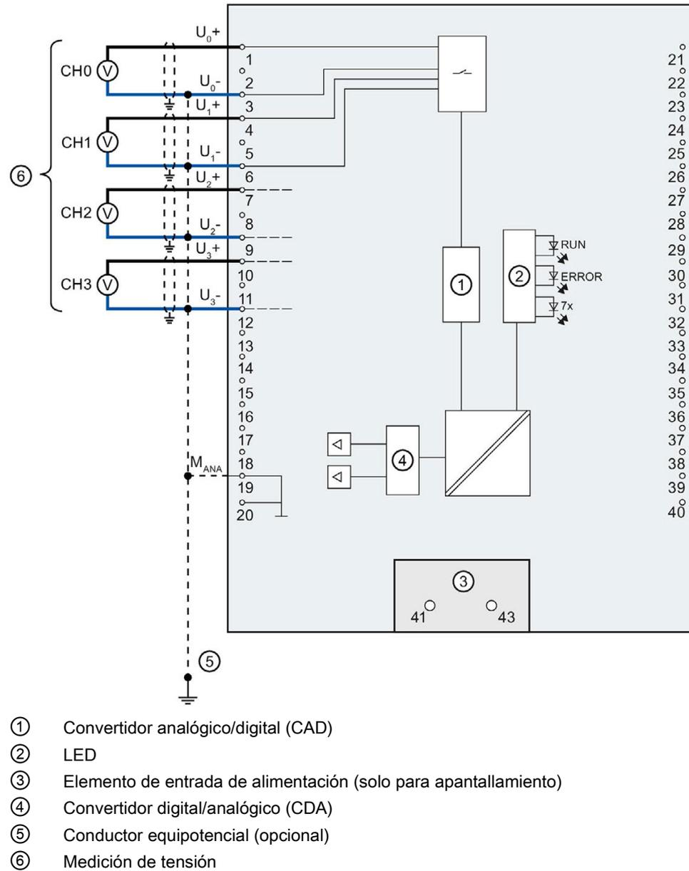
Figura 4-3 Esquema de principio y conexiones para medición de tensión
