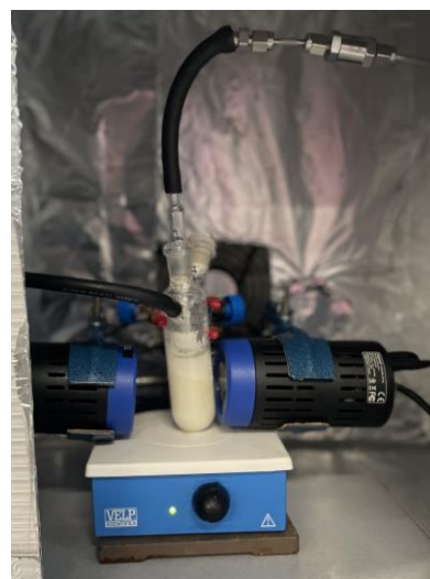
18. Irudia. Fotokatalisi erreaktorea. Ezkerreko argazkia errektore hutsa eta eskumakoan erreaktorea fotokatalizatzaile batekin eta instalazioan jarrita
