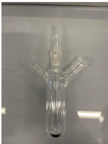
18. Irudia. Fotokatalisi erreaktorea. Ezkerreko argazkia errektore hutsa eta eskumakoan erreaktorea fotokatalizatzaile batekin eta instalazioan jarrita
