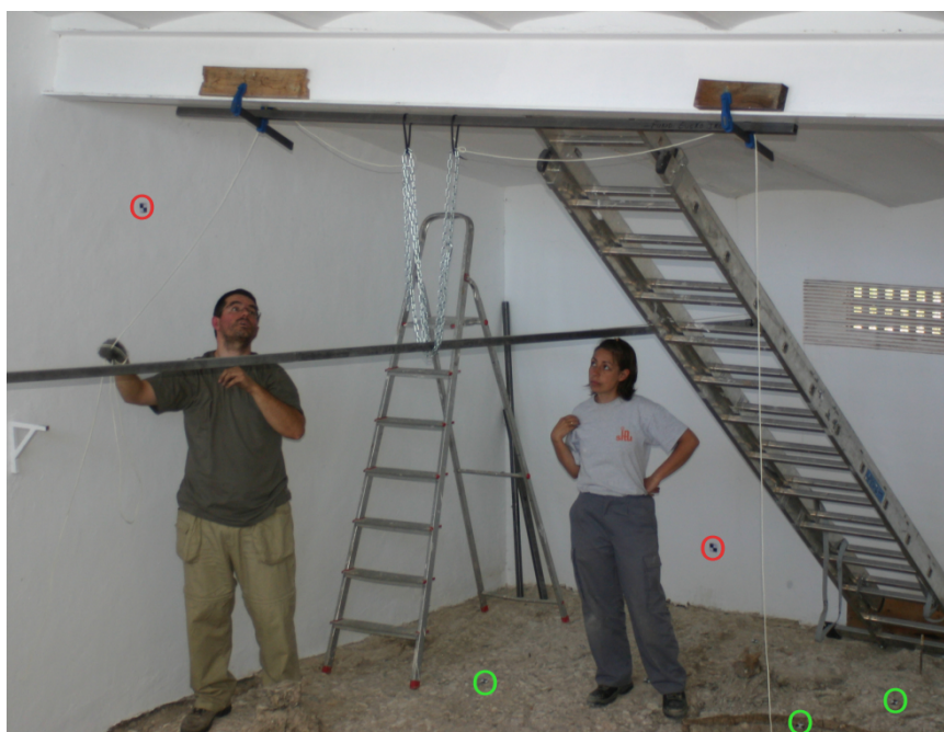
Figura 7. Imagen en la que pueden apreciarse las dianas de referencia, rodeadas de rojo y los puntos apoyo fotogramétrico, alguno de los cuales se han rodeado en verde.
