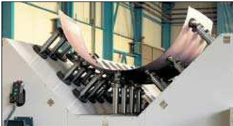
*Figura 1. 3: Sistema Flexible de sujeción de piezas Torrestoll® del fabricante MTorres.*
