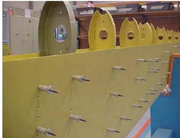
Figura 1.13: Montaje de una estructura tipo caja con elementos temporales de fijación.
