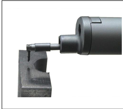
Figura 3. 15: Medición del tamaño de la rebaba con un rugosímetro.
