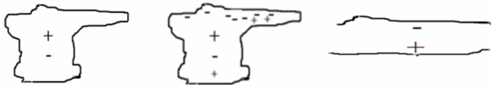
Figura 1. 8. Modelos de distribución de carga en la nube. Izquierda: Modelo bipolar (dipolo positivo). Centro: Modelo tripolar con capa apantalladora. Derecha: Dipolo invertido (nubosidad estratiforme).
