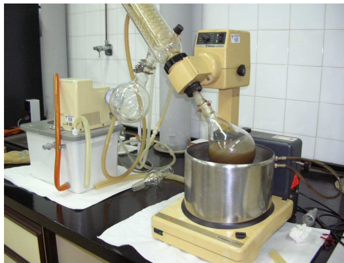
2.13. Irudia. Errotabaporean lur garbia PAHekin dopatzen.
