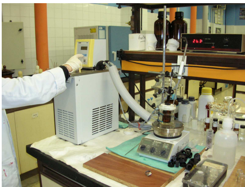
2.1. Irudia. Lurretan HS-SPME-aren bidezko erauzketak egiteko ur-termostatoa eta lagin irabiatzailea.
