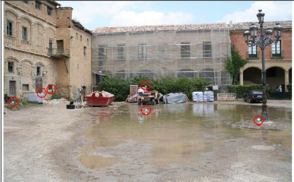
Fig. -14- Muestra de la distribución de las esferas de apoyo durante los barridos del escáner.
