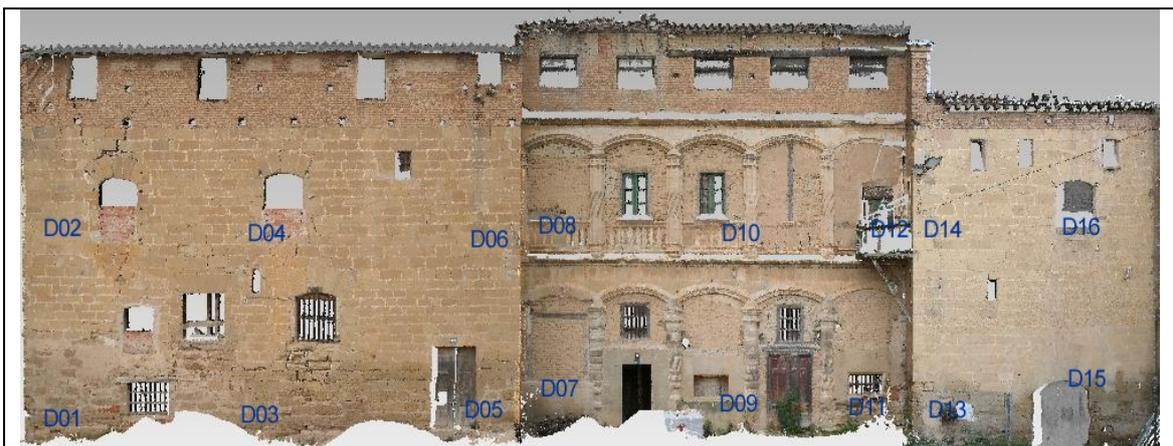
Fig. - 26 - Captura de la nube de puntos en donde se muestra la posición de las dianas. Impares las de la zona baja y pares las de la zona media. En la parte superior no se pudieron colocar , por lo que la comprobación se hizo por medio de puntos singulares, tales como esquinas y aristas.
