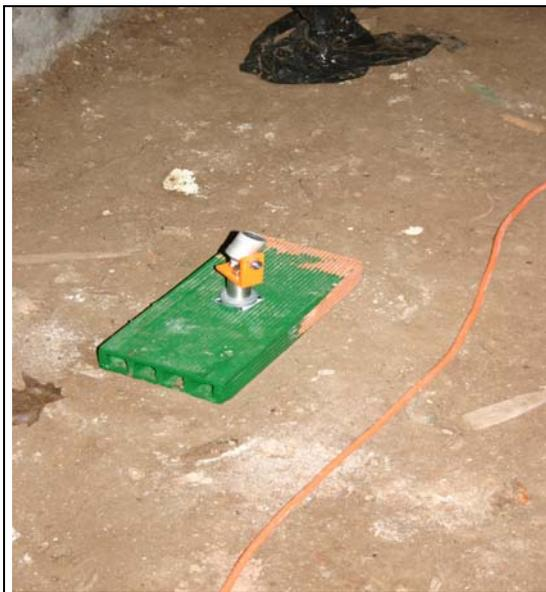
Fig. - 12 - Vista del miniprisma utilizado para determinar las coordenadas de las esferas con la estación total.
