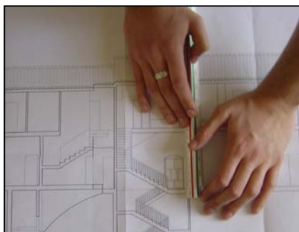
Img. 6.5. Medición de la altura en las secciones.
