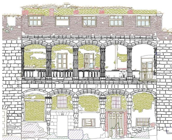
Fig. 1.1.: Elementos restituidos a partir de pares fotogramétricos. Palacio de los Condestables, Casalarreina. (LDGP. 2006).
