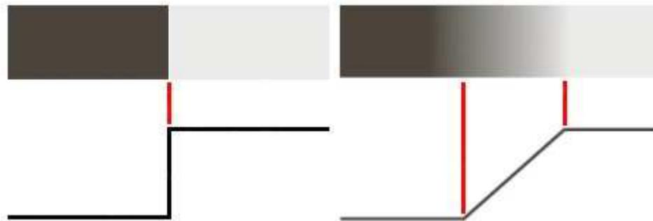
Fig. 3.1.: Borde ideal (izquierda) y borde tipo rampa (derecha).
