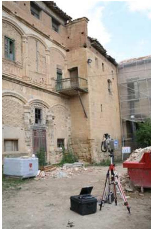
Fig. 2.9.: Escáner tridimensional durante la toma de datos en el Palacio de los Condestables. Junio de 2006.
