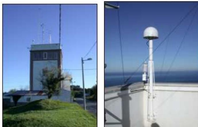
Imagen 33: Muestra una foto del observatorio y otro de la antena AT504 LEIS.
