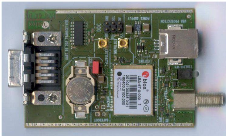
**Imagen 36: Muestra el módulo GPS con el chip LEA 6T**
