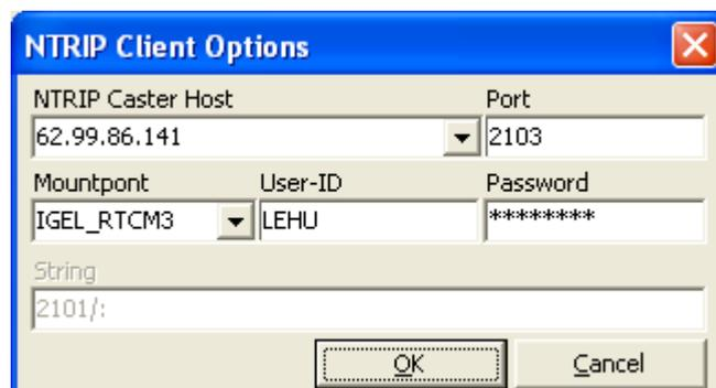
**Imagen 40:** Muestra la pantalla donde se introducen los datos de conexión de la estación base
