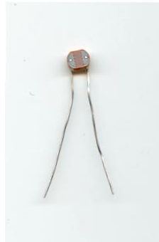
2.18 Irudia. Argiarekin aldatzen den erresistentzia (LDR)
