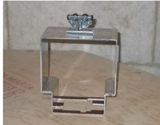
Fig.15 y 16 Diseño del despiece y modelo mecanizado del soporte que circula bajo el rail suspendido
