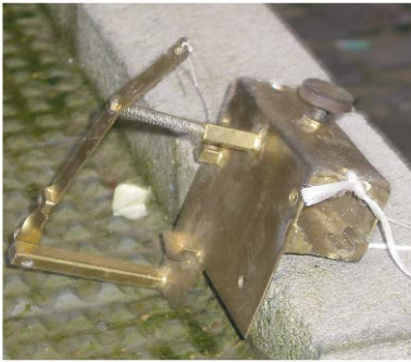
Fig. 8 y 9.- Modelos para el soporte y disparo remoto, adaptado a dos cámaras fotográficas diferentes
