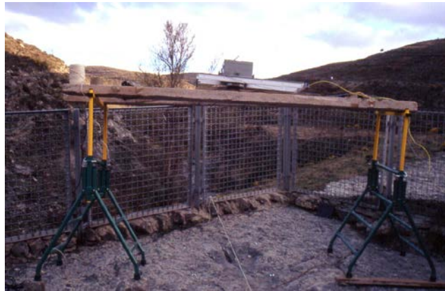
Fig. 2.- Dispositivo de sustentación con UMK
