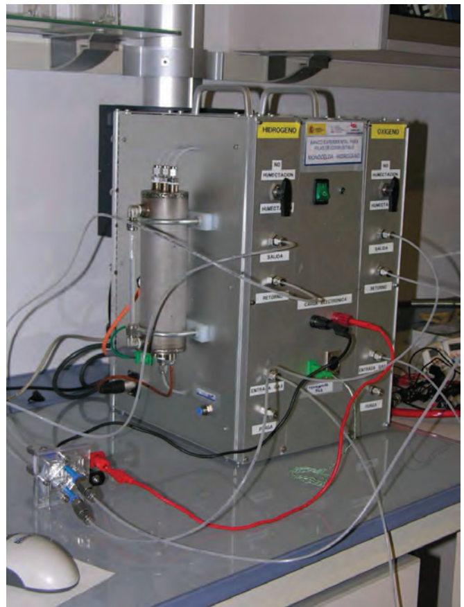
Figura 1. Estación de pilas de combustible del grupo. ( http://www.sc.ehu.es/iaweb/IMAGENES/FOTOSLAB/DSCN2682.jpg )
