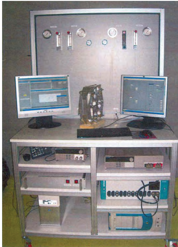
Figura 7-29. Banco de ensayos dual para pilas de combustible de tipo PEM
