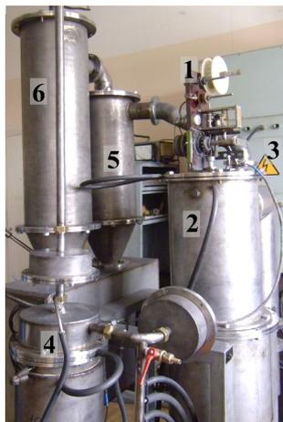
**Figura 2.1:** Vista general del equipamiento diseñado en el Instituto de Electrofísica RAS para la producción de FeNi mediante la técnica de explosión eléctrica de hilo. 1- mecanismo de alimentación del hilo; 2- cámara de reacción; 3- fuente de alto voltaje; 4- ventilador de circulación de gas; 5- ciclón; 6- filtro.
