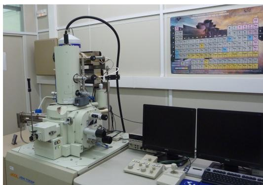
**Figura 2.6:** Vista general del microscopio electrónico de barrido (SEM).
