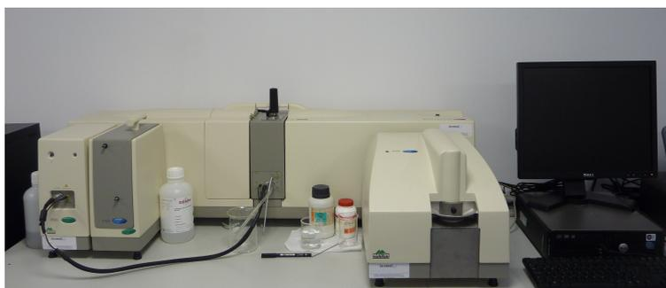
**Figura 2.8:** Vista general de Mastersizer 2000 de Malvern Instruments que emplea la técnica de difracción de rayo láser.
