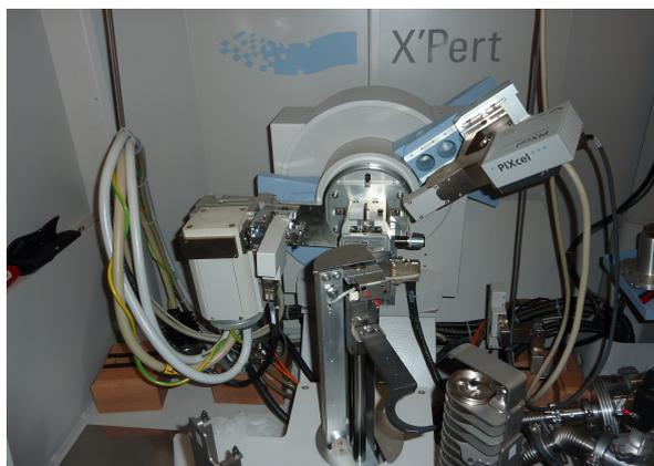
**Figura 2.2:** Vista general del difractómetro operativo automático PHILIPS X'PERT PRO.
