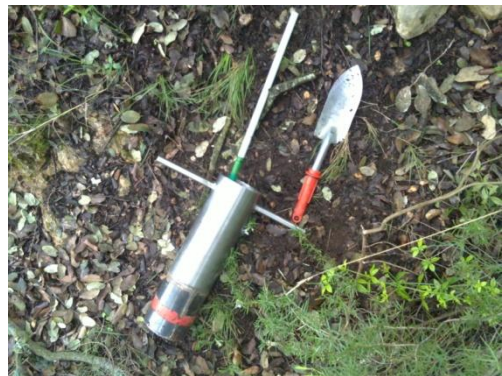
Figura 3: Corer y pala de extracción de muestras de suelo
