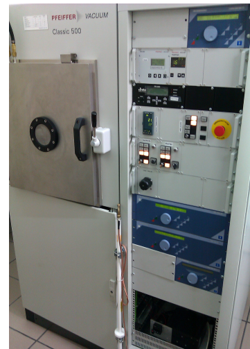
Figura 9. Cámara de sputtering Pfeiffer Vacuum Classic 500
