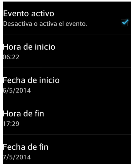
Ilustración 52. Ventana de configuración del evento puntual de un relé
