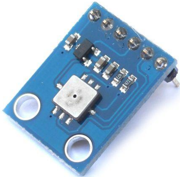
Ilustración 8. Módulo de sensor, para medir temperatura y presión. Fuente: www.emartee.com
