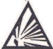
RIESGO DE EXPLOSION
