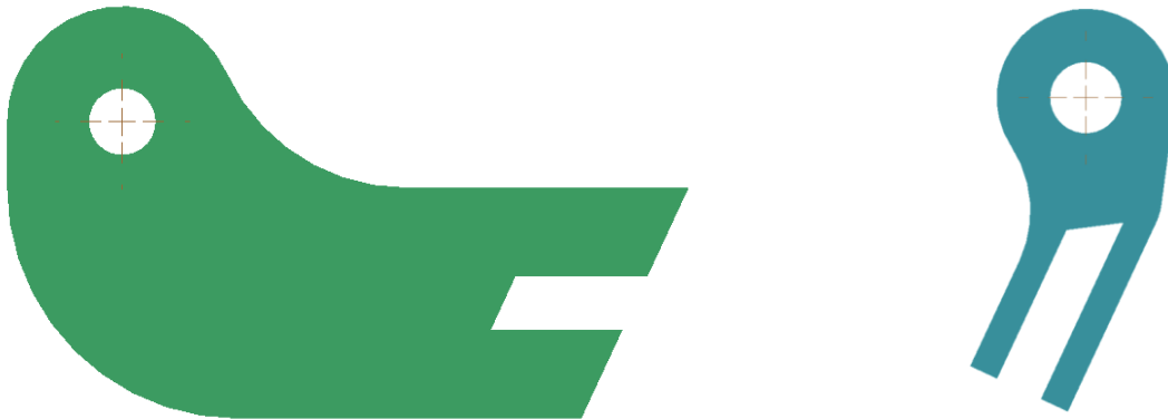
Figura 225. Oreja de unión al muelle 6 mm espesor (Izqda.) y de unión a la bieleta 9 mm (dcha.).
