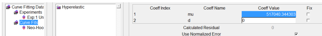
Fig. 36. Obtención de parámetros para Neo-Hooke con densidad 0.68 \text{ g/cm}^3 para probetas pequeñas mediante curve fitting.
