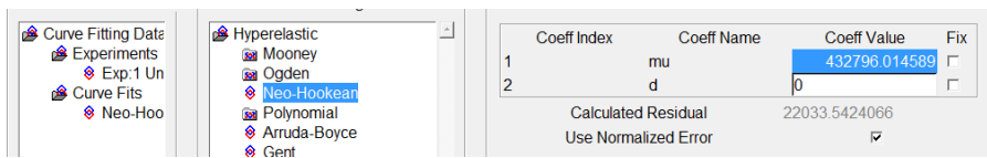
Fig. 34. Obtención de parámetros para Neo-Hooke con densidad 1.03 g/cm 3 para probetas grandes mediante curve fitting.
