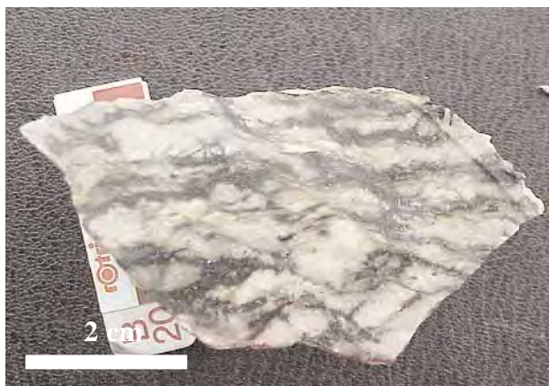
Foto III.1.- Fotografía de visu de los gneises biotíticos porfídicos. Son facies de grano más fino y mucho más ricas en biotita que la facies común.
