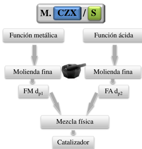
Figura 12. Preparación del catalizador con mezcla de funciones con diferente diámetro de partícula empastilladas por separado.
