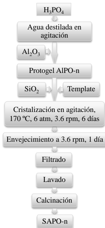
Figura 10. Etapas de preparación de la función ácida.
