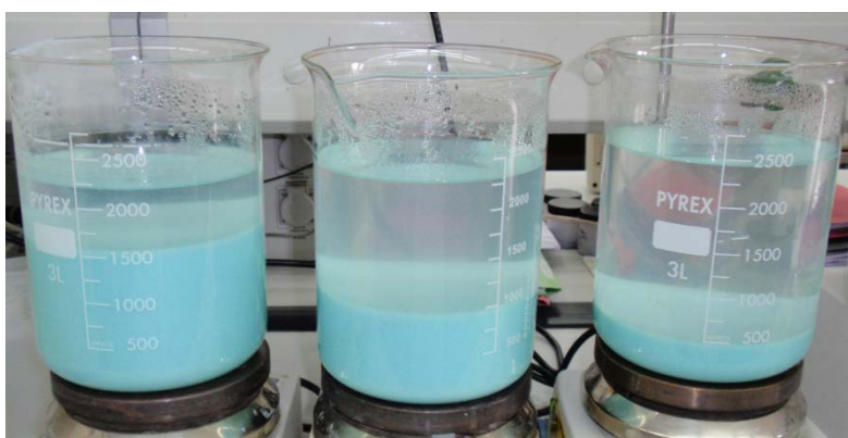
Figura 6. Progresión de la etapa de decantación en la preparación de la función metálica Cu-ZnO-ZrO 2 .
