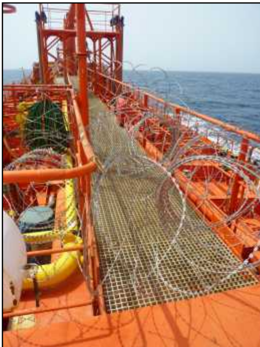
Figura 29. Alambre de espino para evitar acceso a la habilitación.
