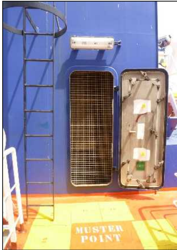
Figura 20. Acceso a la sala de maquinas del MV Mar María con una puerta enrejada.
