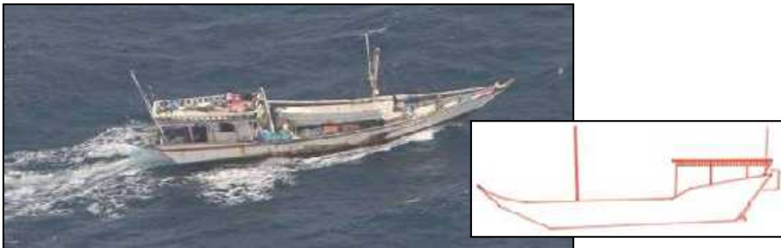
Figura 38. A la izquierda Dhow tipo Yemeni y a la derecha su esquema.
