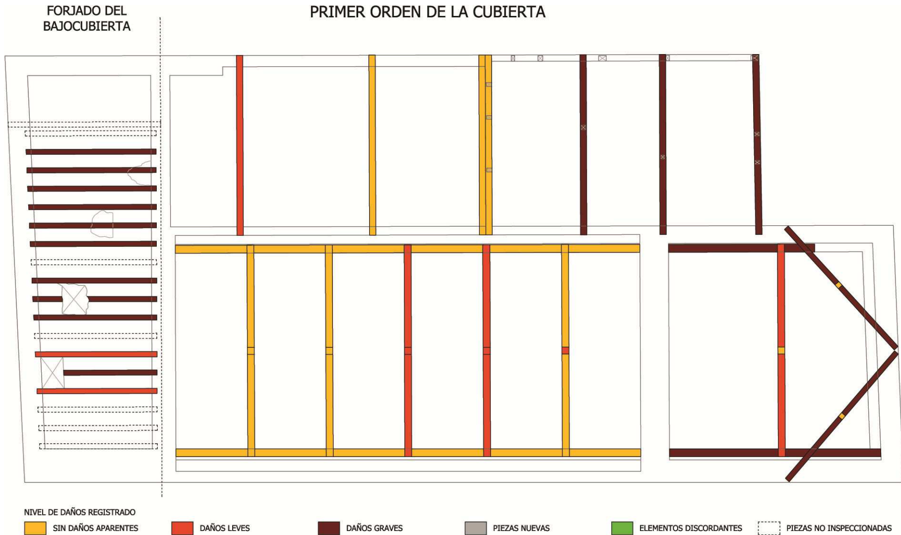
Figura 85. Planos de estado. Primer orden de la cubierta y forjado del bajocubierta de la parte meridional
