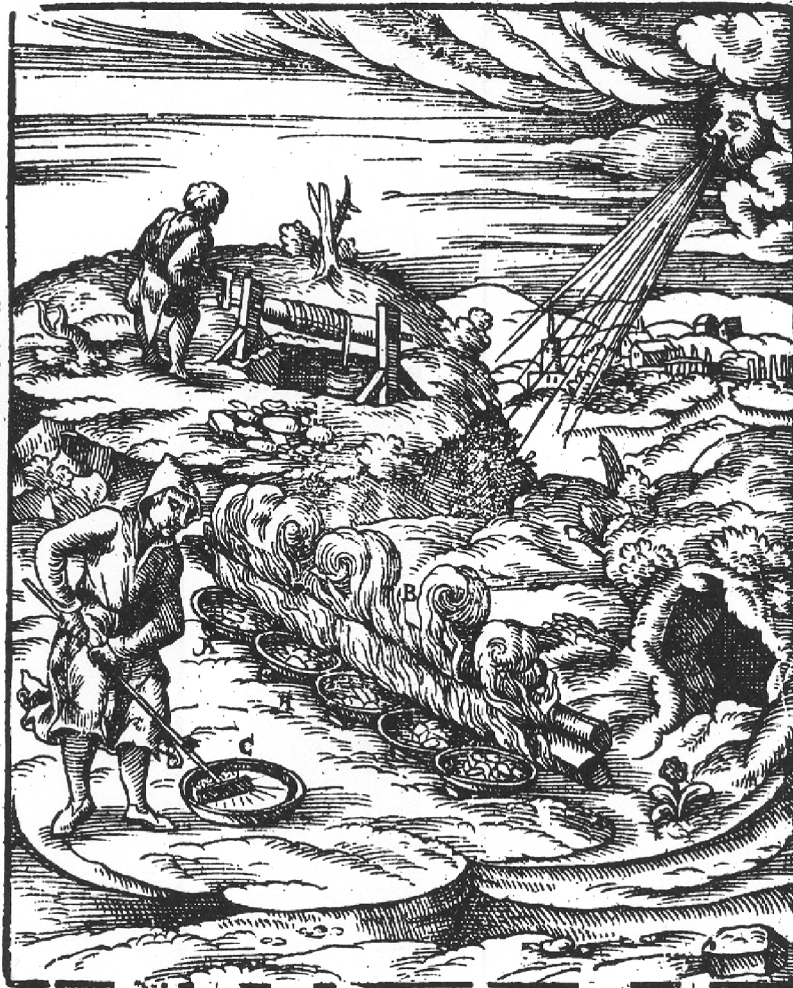
Fig. 1.—Obtención del bismuto en el siglo XVI (Erker, 1736).
