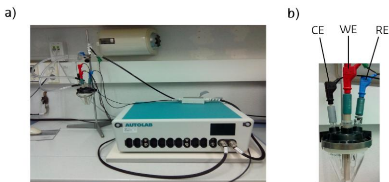
13. Irudia a) Metrohm Autolab boltametroa. b) Zelda elektrokimikoa; WE: lan-elektrodoa, RE: erreferentzia-elektrodoa, CE: elektrodo osagarria.
