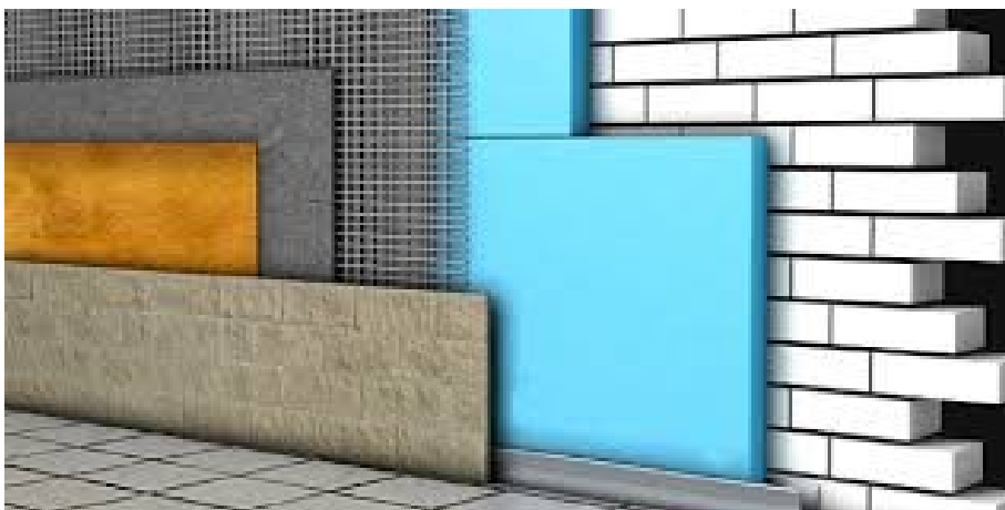
Figura 6. Esquema de aislamiento sobre pared.
