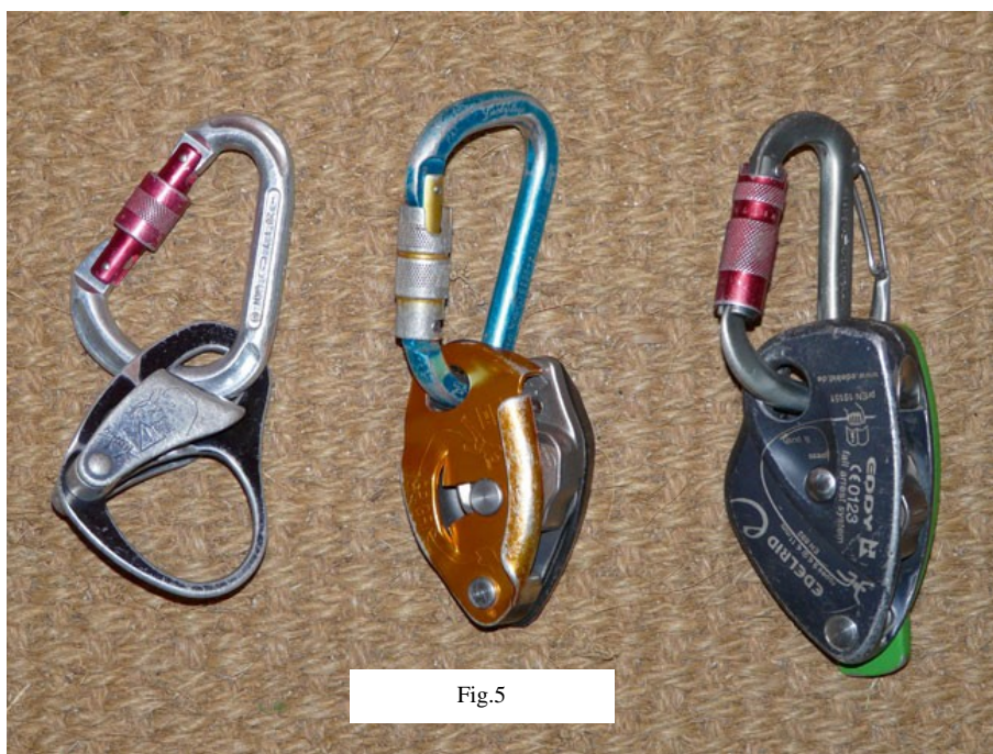
De izquierda a derecha: aparato asegurador manual sobre mosquetón de rosca normal; y dos aparatos automáticos
