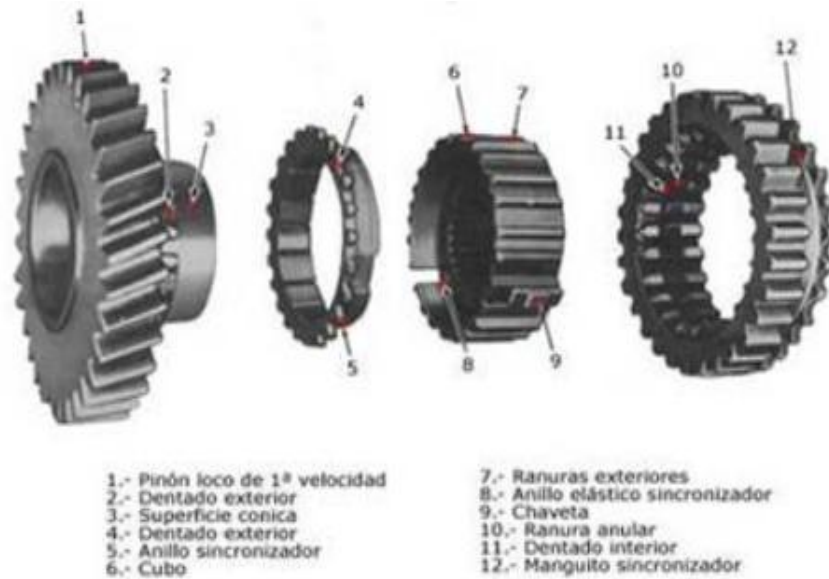
Figura 34: Despiece de un sincronizador
