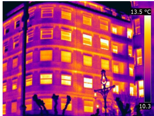
Ilustración 24: termografía de un edificio que muestra diferentes puentes térmicos.
