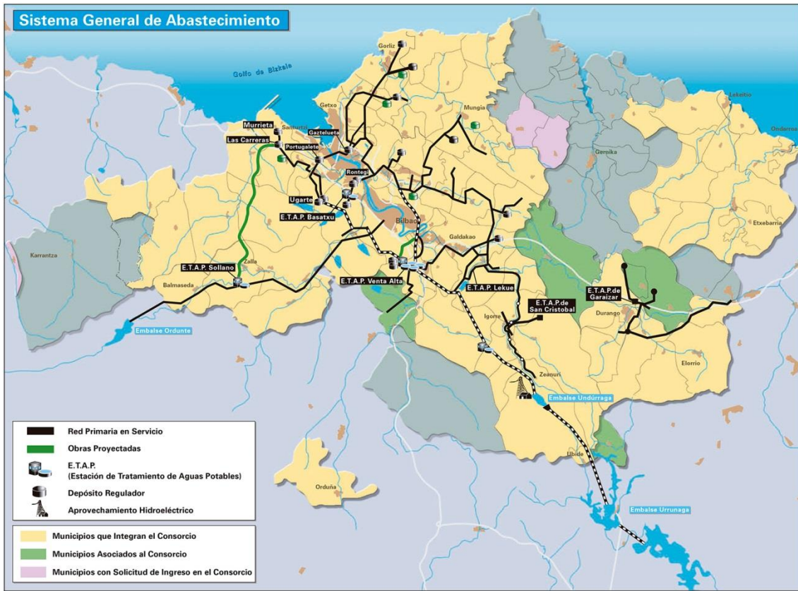
Ilustración 1: Sistema General Abastecimiento
