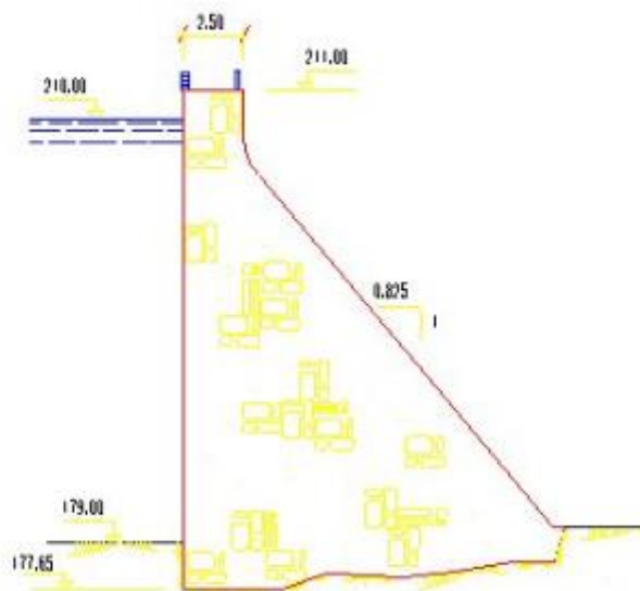
Ilustración 28: Sección transversal de la presa de Zollo
