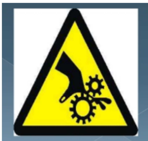
Imagen 7.1: riesgo por atrapamiento
