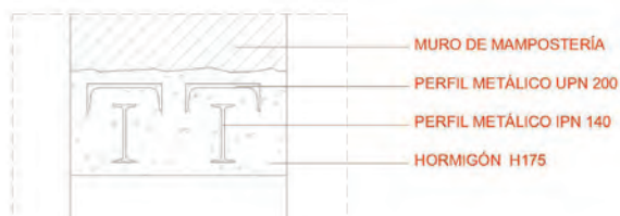
FIGURA A20. 21. DETALLE DE SOLUCIÓN PROPUESTA PARA AUMENTAR HUECO DE ESCAPARATE EN MURO DE CARGA 12
