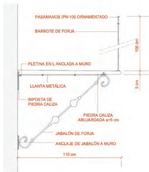
FIGURA A1. 36. 2003 DETALLE CONSTRUCTIVO DE NUEVO BALCÓN
