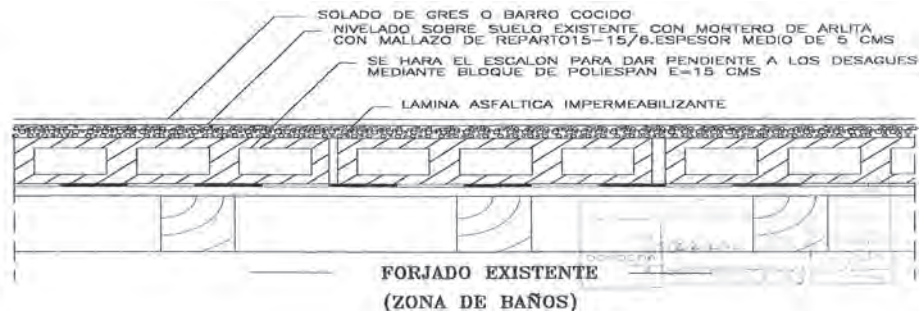
FIGURA A19. 22. 2002 FORJADO PROYECTADO EN ZONA DE BAÑOS
