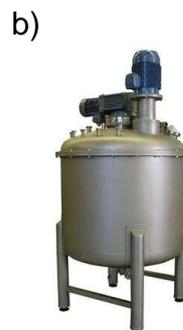
Esquema del reactor químico con camisa de calefacción/refrigeración.
