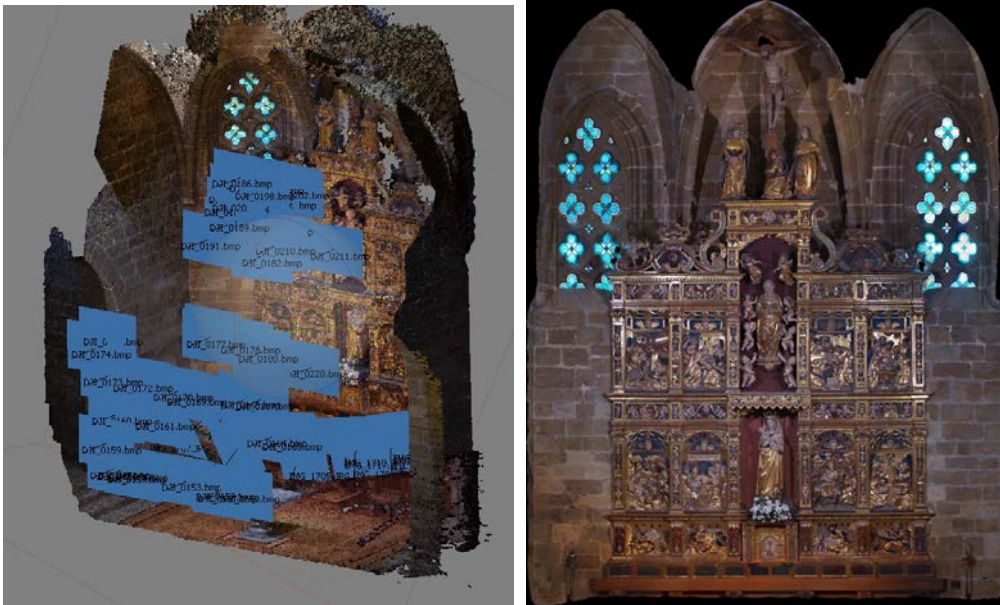
Fig. 26.- Modelo 3D del retablo mayor (izquierda) y vista ortográfica del alzado frontal.
