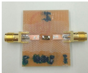
Figura 2.17: Portamuestras realizado en una placa PCB con las líneas microstrip y los conectores SMA.
