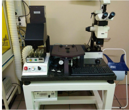
Figura 2.9: Equipo de alineación y exposición de la sala blanca de la Facultad de Ciencia y Tecnología.
