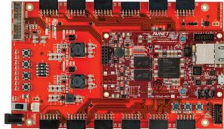
Figura 3.2: Vista de la I/O Carrier con la MicroZed.
