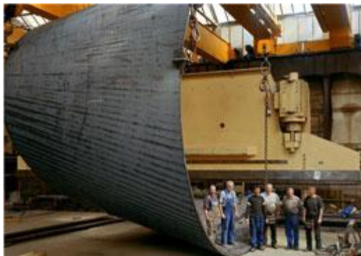
(fig.101) En Pickhan Unforntechnik unos operarios posan ante la máquina curvadora que gradualmente dobla cuidadosamente el acero como es la plancha de una de las obras de Serra que se observa en la imagen.
