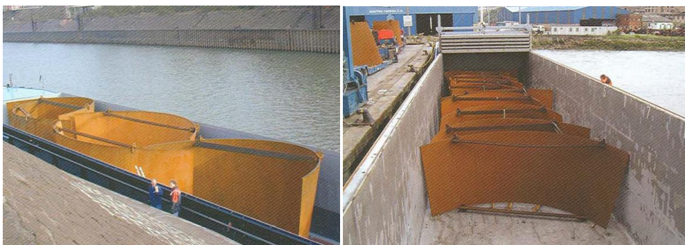
(figs.105 y 106) Disposición de las planchas en la bodega de la embarcación.
