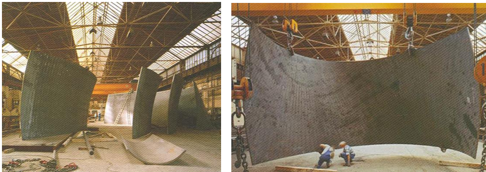
(figs.102 y 103) Planchas de acero autopatinable de las obras de “La Materia del Tiempo” en la empresa alemana Pickhan Unformtechnik durante el proceso de fabricación.
