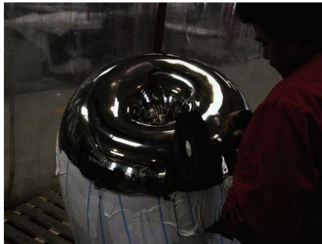
(fig.155, 156 y 157) Algunos momentos del proceso de producción de "Tulipanes. Una vez hecha cada pieza individualmente, que conformará la totalidad de la escultura, se pulirá en un proceso que, para piezas como "Tulipanes", suele durar unas 250 horas.
