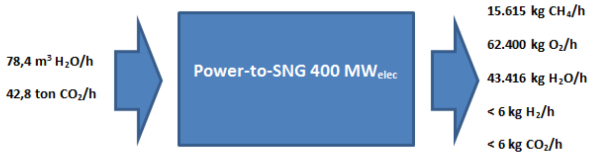
Figura 57 : Balance másico total CASO 4: Central de Power-to-Methane de 400Mw e de Input
