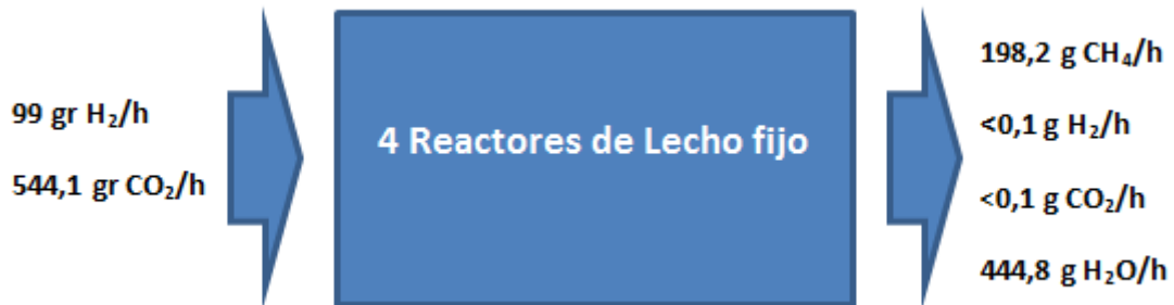
Figura 35: Balance mássico del proceso de metanización de la planta de Rozenburg
