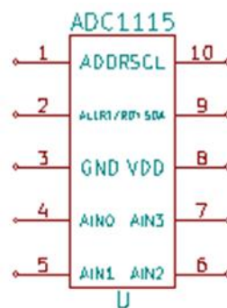
Irudia 38: Schematik library editor erabiliz diseinatutako ADC1115
