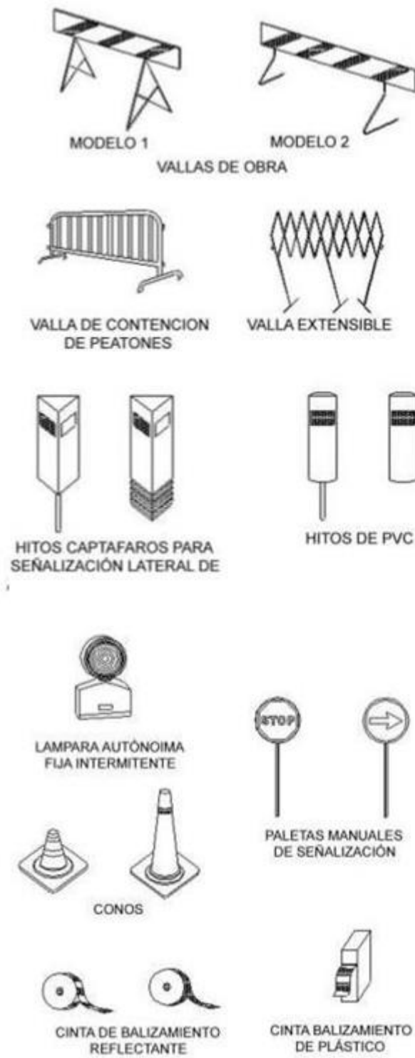
Figura 3: Señalización y balizamiento en obra. [Elaboración propia]
