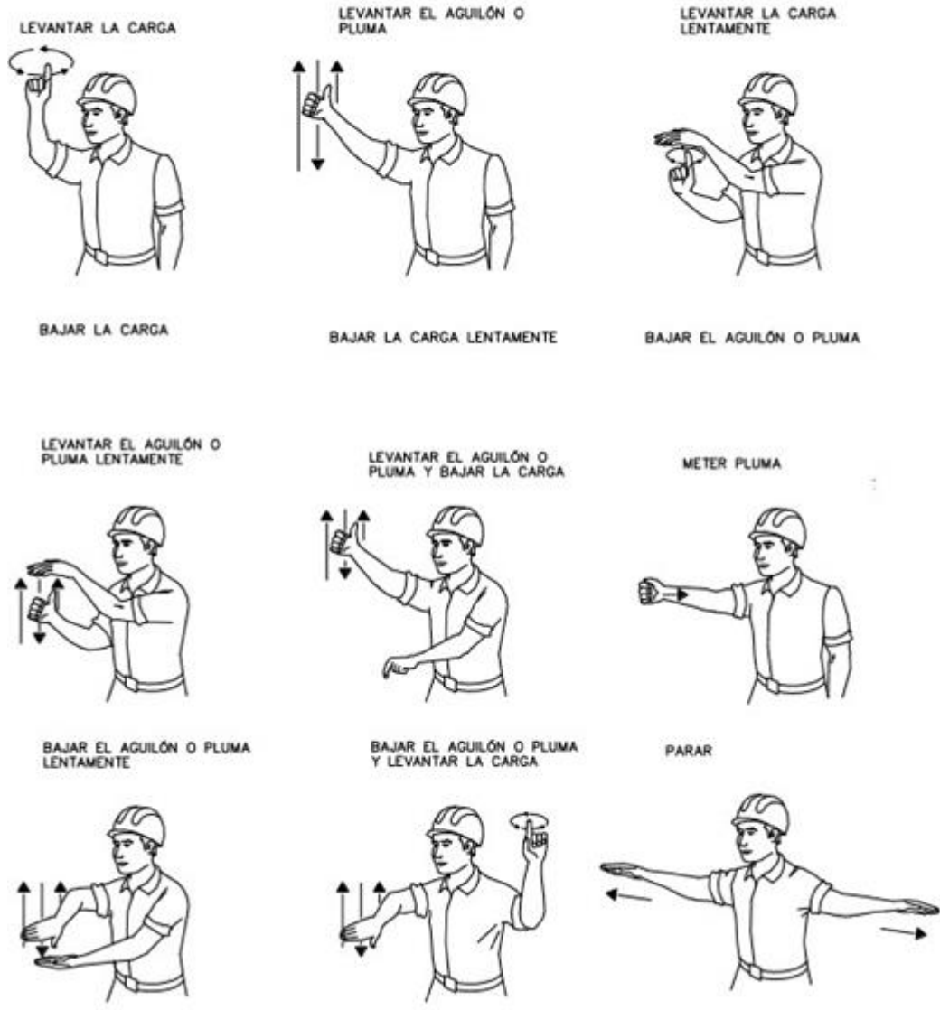
Figura 4: Código de señales de maniobras. [Elaboración propia]
