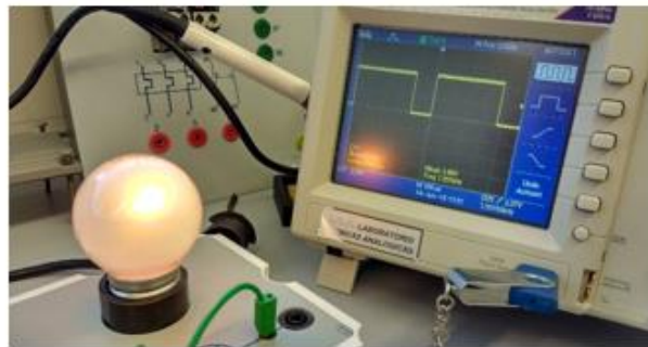
Figura 38- Señal PWM Duty Cycle: 15%
