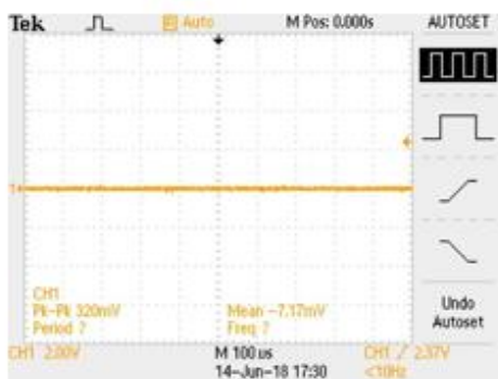
Figura 40- Señal PWM Duty Cycle: 100%
