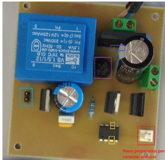
Figura 33- Circuito de control y potencia- PCB
