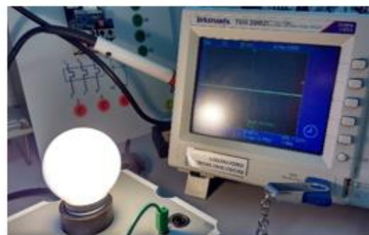
Figura 40- Señal PWM Duty Cycle: 100%
