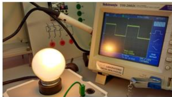
Figura 39- Señal PWM Duty Cycle: 50%
