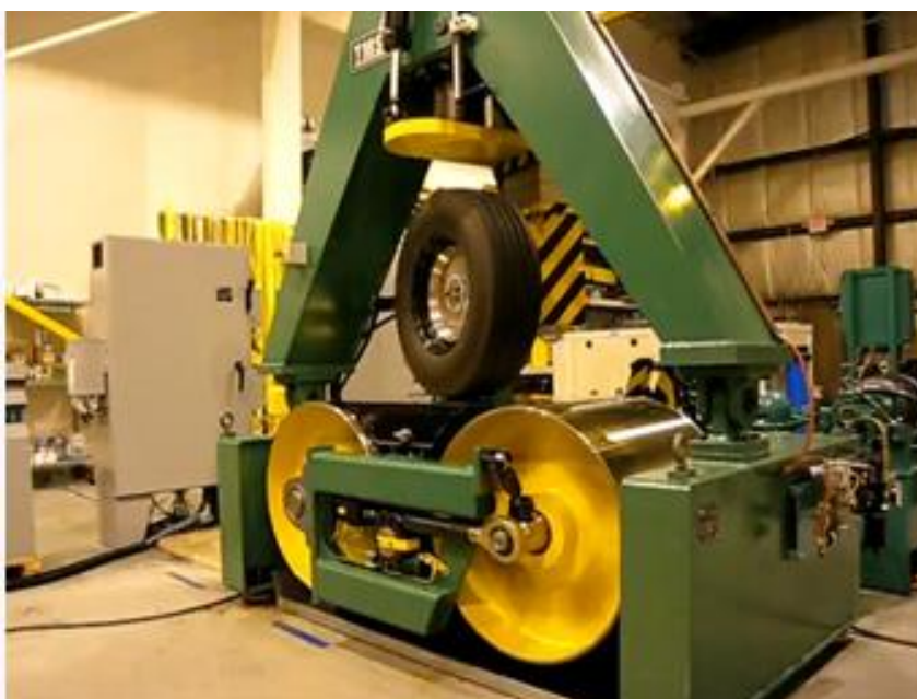
5. IRUDIA: Gainazal laueko errodadura saiakuntza-bankua.
