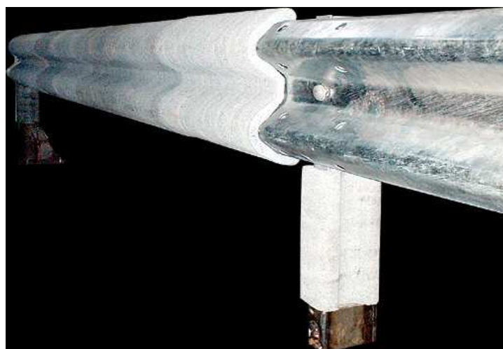
2-3 Irudia. Kautxu birziklatuarekin eta dentsitate txikiko polietileno linealarekin egindako nahasketa errepideko hesi batean jartzeko simulazioa
