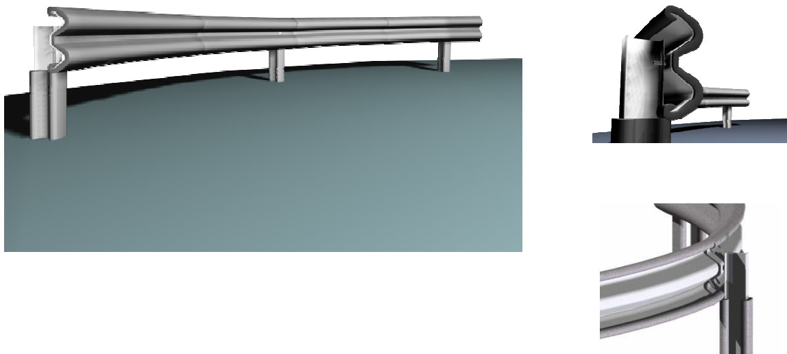
2-3 Irudia. Kautxu birziklatuarekin eta dentsitate txikiko polietileno linealarekin egindako nahasketa errepideko hesi batean jartzeko simulazioa
