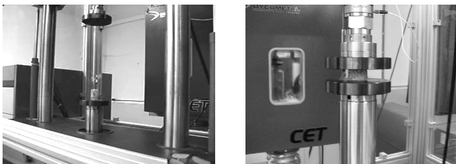
3-9 irudia. MTS abiadura handiko saiakuntza sistema, LEARTIKEReko saiakuntza mekanikoen laborategian
