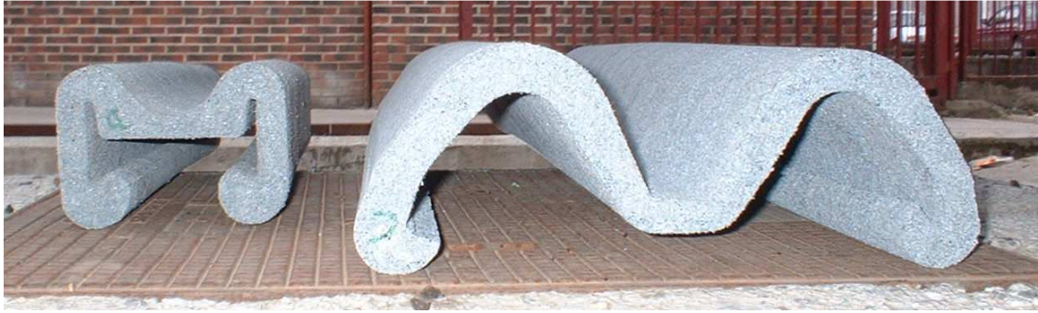
2-1 Irudia. Kautxu birziklatuarekin eta dentsitate txikiko polietileno linealarekin egindako nahasketaren laginak, segurtasun hesi eta zutabe itxurakoak.
