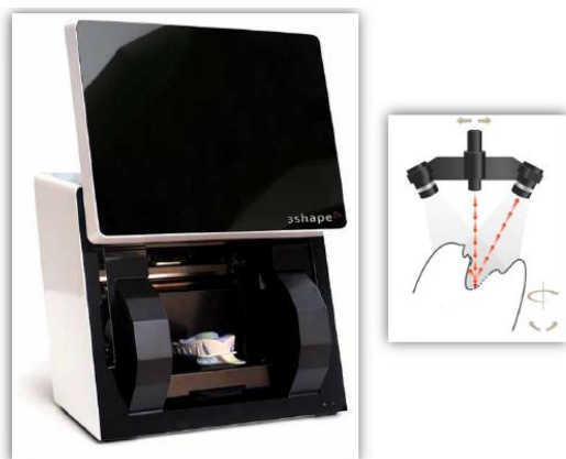
Irudia 3: 3Shape eskanerra eta bere ekintza mekanismoa
