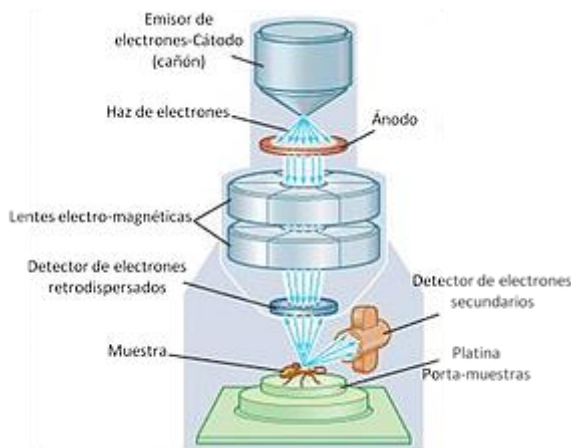
Irudia 6: mikroskopia elektronikoaren funtzionamendua
