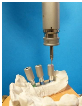
Irudia 12: Koordinatu bidezko neurketa makina. Ukipen zunda eskaneatze gorputza neurtzen.
