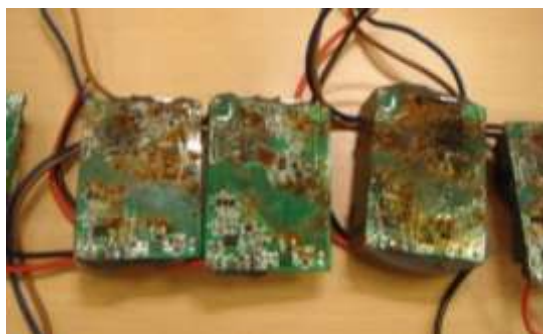
Figura 7.18 Estado del circuito interior de luminaria LED tras una sobretensión sin puesta a tierra
