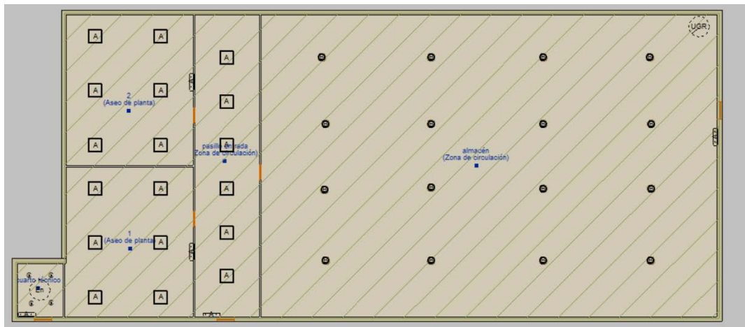
Figura 18. Distribución de luminarias
