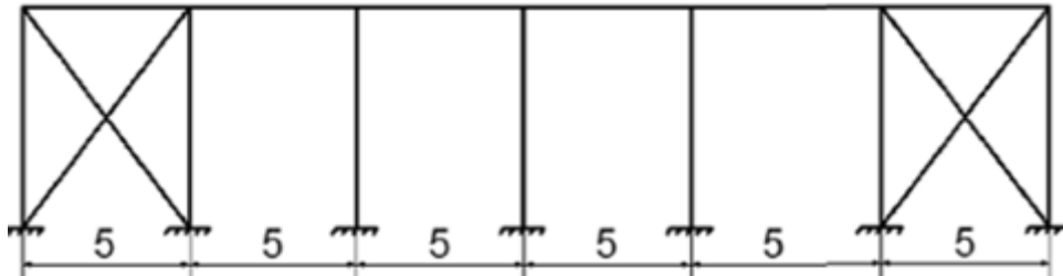
Figura 5.2. Separación entre pórticos
