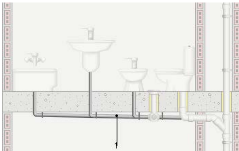
Figura 16. Ejemplo de red de pequeña evacuación
