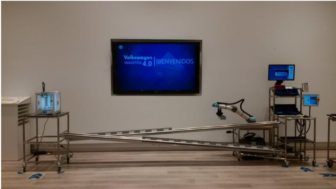
Figura 14. Impresora 3D, cinta transportadora y robot colaborativo. Fuente: Volkswagen Navarra
